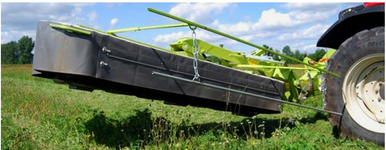
Abb. 10: Beispiel für einen einfachen Anbau an ein Mähwerk, der dadurch, dass er die Vegetation direkt vor der Mahd abstreift, manche Mahdverluste vermeiden kann, da sich verschiedene Arten (wie Käfer) herabfallen lassen oder (wie beispielsweise Schwebfliegen) davonfliegen (URL 1 [2014]; Foto: Rainer Oppermann i. A. NABU Gärtingen).
